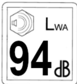
Die Berechnung des gemessenen und garantierten Schallleistungspegels erfolgte nach dem Verfahren der Richtlinie 2000/14/EG, Anhang V.
