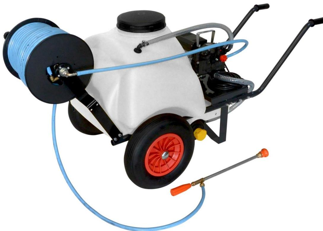
La motopompa a carriola è l'ideale per l'irrorazione di liquidi in alta pressione, è costituita da un telaio in acciaio verniciato con 2 ruote in gomma che ne consentono il facile spostamento sul terreno, un serbatoio in polietilene da 120 Lt, un motore elettrico monofase da 1,5 HP – 230V, una pompa a membrana AR252 da 25 bar di pressione massima, un avvolgitore in metallo, 50 mt di tubo alta pressione ed una lancia a leva in metallo da cm. 65.
