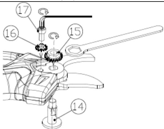
Ievietojiet centrālo skrūvi (14). Pievelciet uzgriezni ar uzgriežņu atslēgu (15). Uzlieciet skavu ar uzgriezni un samontējiet skrūvi (16). Pievelciet skrūvi ar M4 sešstūra atslēgu (17).
