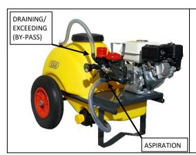
CONNECTION TUBES: CONNECT THE ASPIRATION TUBE OF THE FILTER TO THE HOSE CONNECTION POSITIONED ON THE BOTTOM OF THE MOTOR/ELECTRIC PUMP. THEN CONNECT THE DRAINING TUBE TO THE EXIT OF THE PRESSURE REGULATOR (ON THE TOP OF THE PLASTIC HOSE CONNECTION).
