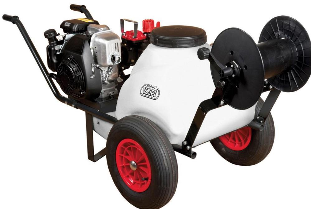
La motopompa a carriola è l'ideale per l'irrorazione di liquidi in alta pressione, è costituita da un telaio in acciaio verniciato con 2 ruote in gomma che ne consentono il facile spostamento sul terreno, un serbatoio in polietilene da 120 Lt, un motore a scoppio RATO R210 – 4 tempi da 5 HP, una pompa a membrana AR252 da 25 bar di pressione massima, un avvolgitore in metallo, 50 mt di tubo alta pressione ed una lancia a leva in metallo da cm. 65.
