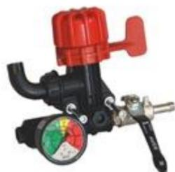
**BY-PASS:** SULLA POMPA AR252 IL REGOLATORE DI PRESSIONE DEVE ESSERE MONTATO TRAMITE 2 VITI IN DOTAZIONE NEL SACCHETTO DEL BY-PASS, INTERPONENDO L'OR PRESENTE NELLA CONFEZIONE. LE 2 USCITE SONO: SCARICO/ECCEDENZA, MANDATA.
