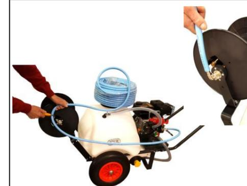
**COLLEGAMENTO AVVOLGITUBO:** IL PORTAGOMMA DI MANDATA DELLA MOTOPOMPA DEVE ESSERE COLLEGATO CON UNO SPEZZONE DI TUBO FINO AL PORTAGOMMA GIREVOLE SITO SU UN DISCO DELL'AVVOLGITUBO SERRARE CON FASCETTA A VITE.
