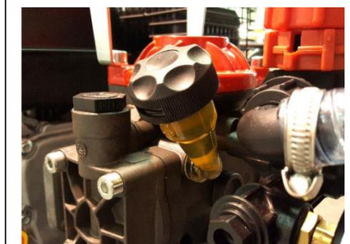
**OLIO POMPA:** L'OLIO DELLA POMPA DEVE ESSERE SEMPRE VISIBILE NEL BICCHIERINO IN ALTO SULLA POMPA, USARE OLIO UGUALE A QUELLO DEL MOTORE.
