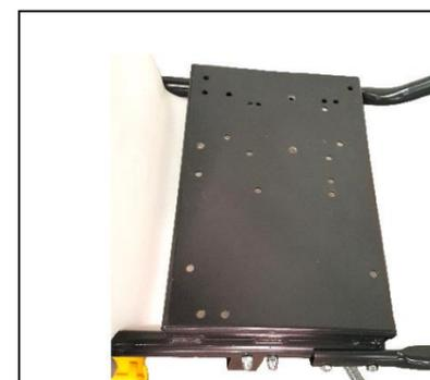
**PIASTRA:** LA PIASTRA SALDATA AL TELAIO DELLA CARRIOLA PORTA DIVERSI FORI PER COLLEGARE I VARI MODELLI DI MOTORE, NELLA DOTAZIONE DELLE ISTRUZIONI VEDASI IL FOGLIO CON LE ISTRUZIONI CON INDICATI QUALI FORI ADOPERARE E QUINDI COME POSIZIONARE IL BASAMENTO DEL MOTORE.
