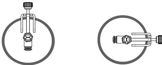
*20ATM può essere applicato in qualsiasi posizione radiale rispetto al tubo. Tuttavia, quando la bocca del soffiatore lo consente, si consiglia di agganciare 20ATM alla parte superiore della bocca del tubo (prima illustrazione). Ciò permette un maggiore controllo visivo del tubo e di 20ATM.*
